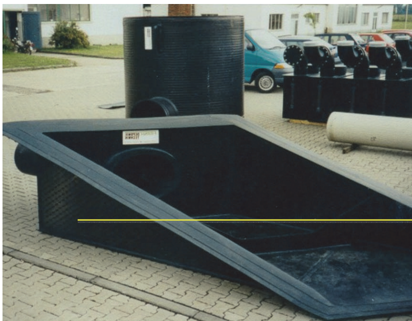
Figure 15. Préfabrication d'un ouvrage de sortie
