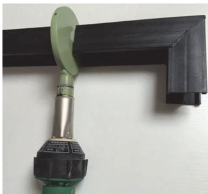
Figure 4. Soudure au miroir
